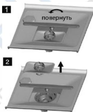
Шаг 1. Поверните верхнюю часть блока фильтров против часовой стрелки.
